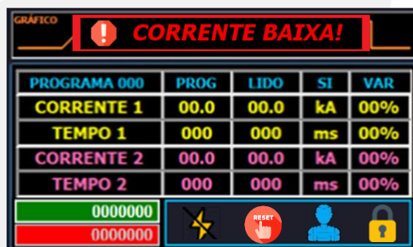
Figura 30 – Erro corrente baixa.
