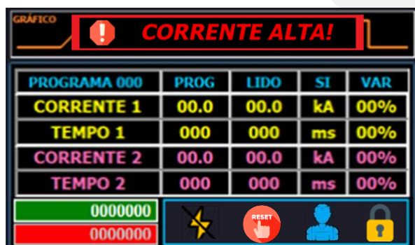
Figura 29 – Erro corrente alta.
