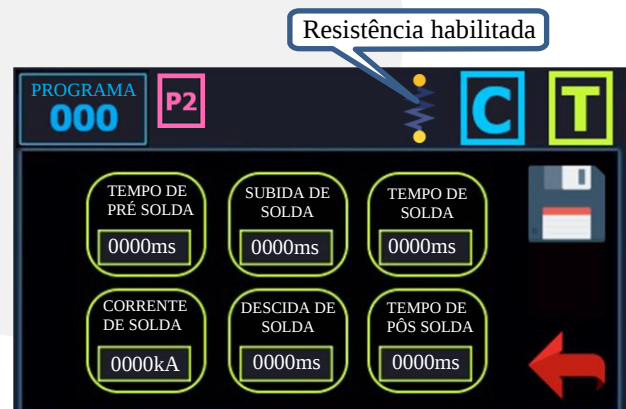
Figura 36 – Parâmetros de solda com resistência habilitada.
