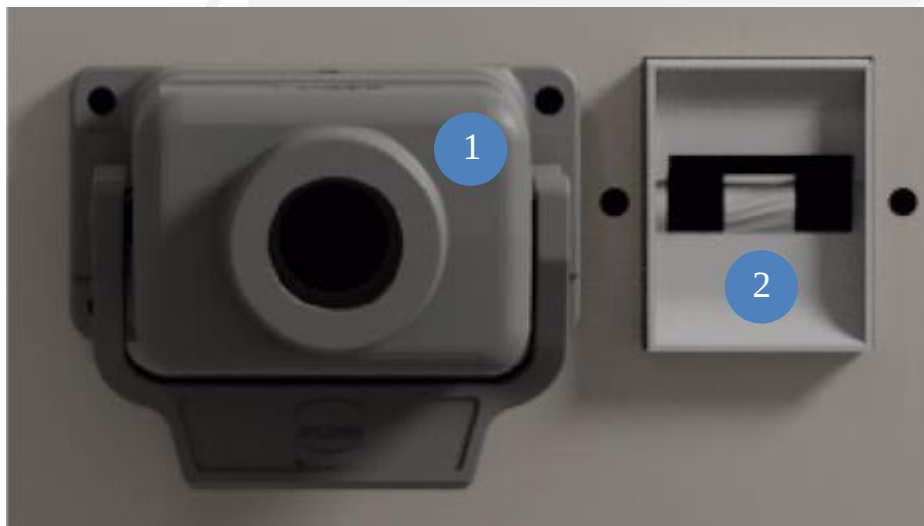
Figura 5 – Ligação transformador de solda.
