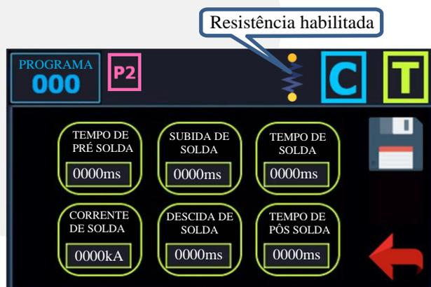
Figura 36 – Parâmetros de solda com resistência habilitada.
