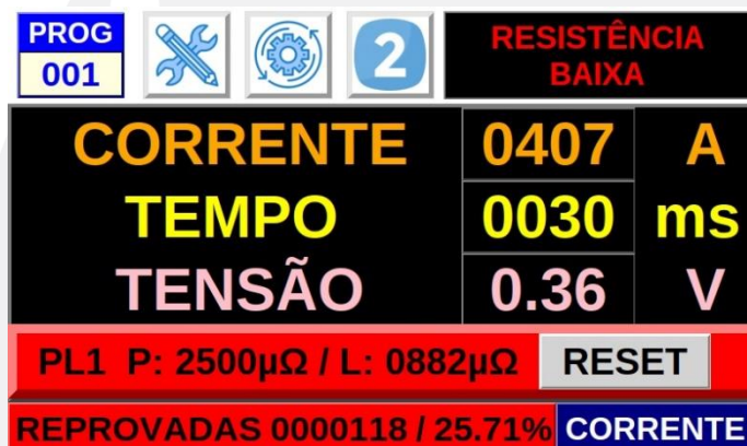
Figura 11 - Tela de operações após uma solda reprovada por resistência.
