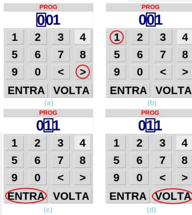
Figura 17 - Exemplo de alteração de programa de 001 para 011, em (a) navega para o dígito que se deseja alterar, em (b) se digita o novo valor do dígito e em (c) se confirma a entrada; já em (d) está o exemplo de cancelamento da entrada.
