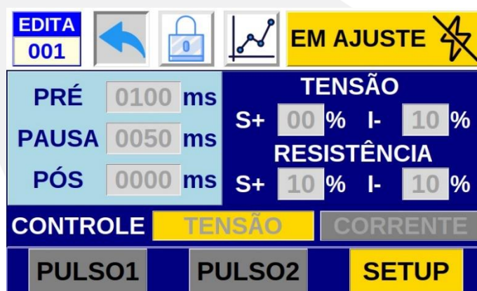
Figura 15 - Tela de programação bloqueada para alterações e com o IHF-1 selecionado para operação em ajuste.
