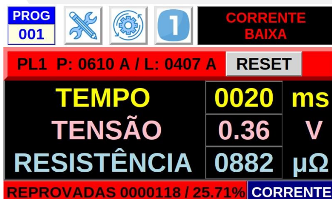
Figura 12 - Tela de operações após uma solda reprovada por corrente (variável de controle).
