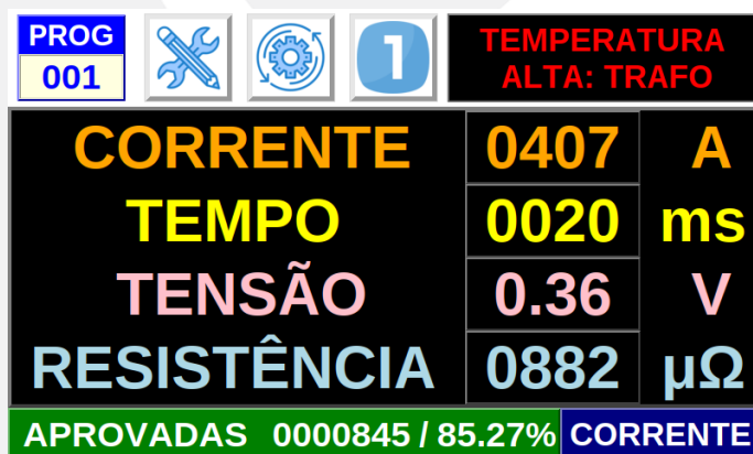
Figura 13 - Tela de operações indicando um erro de sistema que desabilita o processo de solda.
