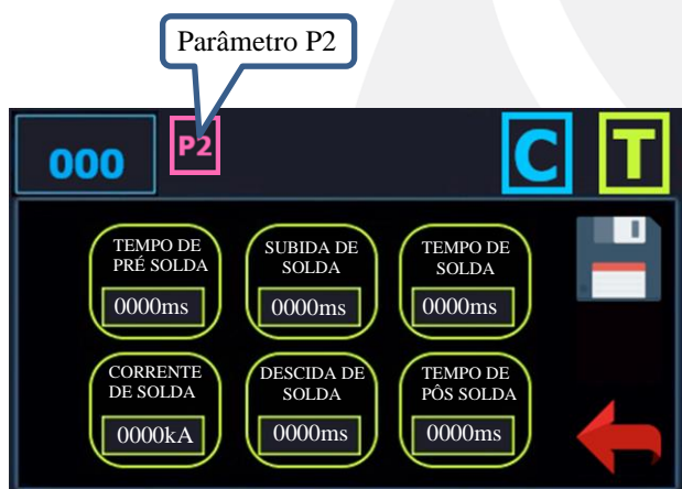
Figura 35 – Tela de edição parâmetros de solda 2.
