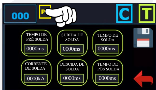
Figura 34 – Tela de edição parâmetros de solda 1.
