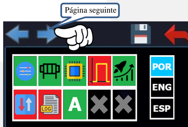
Figura 39 – Configurações do inversor de solda
