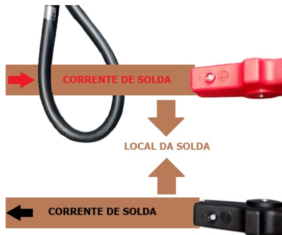
Figura 10 – Esquema de montagem para medições do Weld Checker IWC-107
