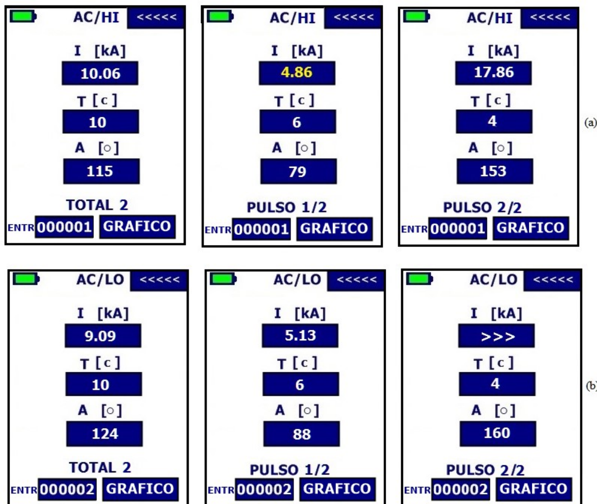
Figura 32 – Apresentação da medição de dois pulsos de solda com escalas diferentes: (a) configuração para escala alta (HI) e (b) configuração para escala baixa (LO)
