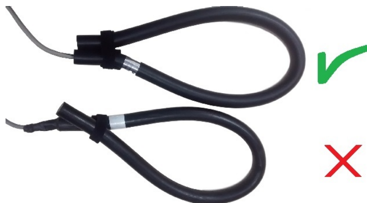
Figura 11 – Posicionamento correto e incorreto do sensor de corrente
