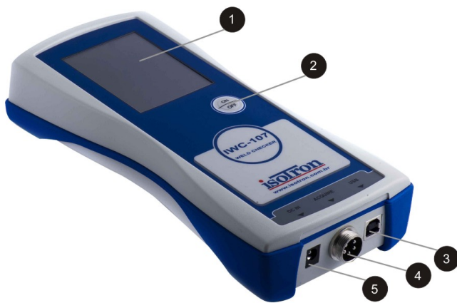
Figura 3 –Weld Checker IWC-107 com descritivo da composição
