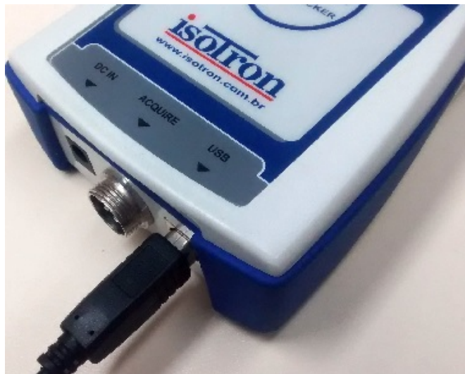
Figura 12 - Conexão de cabo USB para transferência de arquivos
