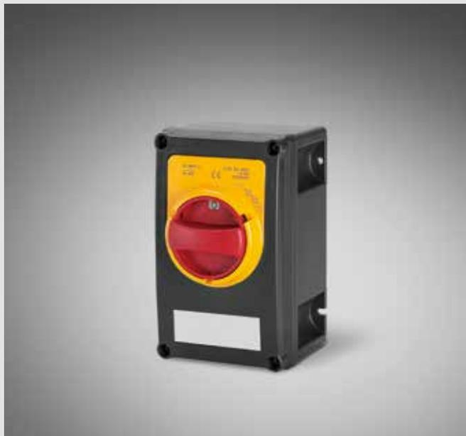
Il tecnopolimero usato per gli ISOLATORS Heavy Duty garantisce una eccezionale resistenza al calore ed al fuoco. Glow Wire 960°C secondo la EN 60695-2-1; 5VA secondo la UL94.
