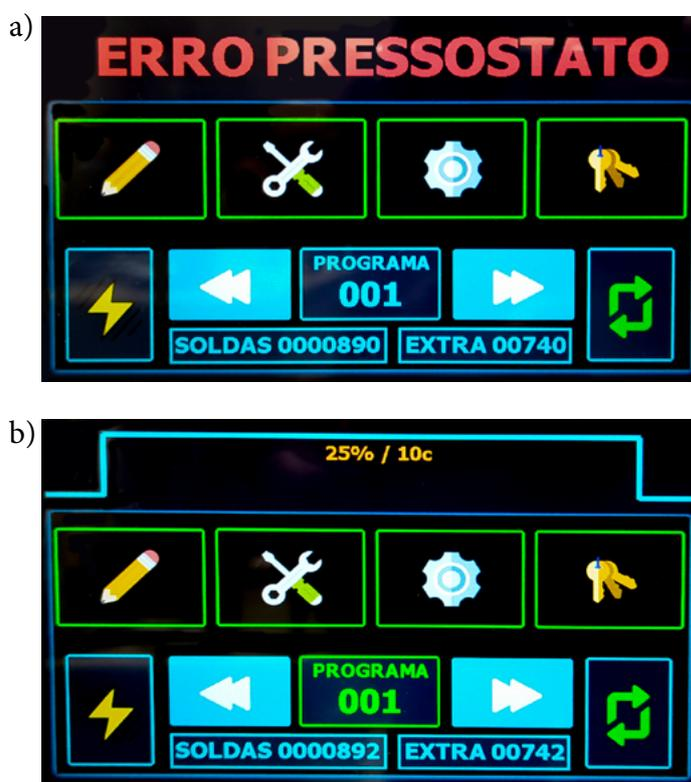
Tela Principal com (a) erro detectado e (b) processo de solda ocorrendo
